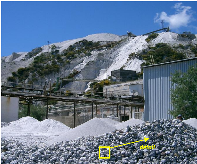
Carrière de ponces de Monte Pilato, au nord-est de l'île Lipari, et détail des ponces qui sont pour partie broyées ultérieurement (tas blanchâtres au 2 e plan). Les ponces sont utilisées dans la fabrication de bétons légers ou comme abrasifs (usure artificielle de textiles...) ou exfoliants. © prepas-svt.fr
