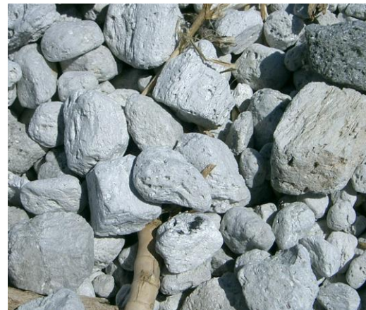
Carrière de ponces de Monte Pilato, au nord-est de l'île Lipari, et détail des ponces qui sont pour partie broyées ultérieurement (tas blanchâtres au 2 e plan). Les ponces sont utilisées dans la fabrication de bétons légers ou comme abrasifs (usure artificielle de textiles...) ou exfoliants. © prepas-svt.fr
