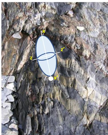
L'ellipsoïde de la déformation finie enregistrée par le pli peut être tracé ( $zz'$  : raccourcissement maximal,  $xx'$  : élongation maximale). Par-contre, le caractère anisopaque du pli (déformation +/- continue et non-coaxiale) ne permet pas de « remonter » aux contraintes et tracer l'ellipsoïde correspondant...
