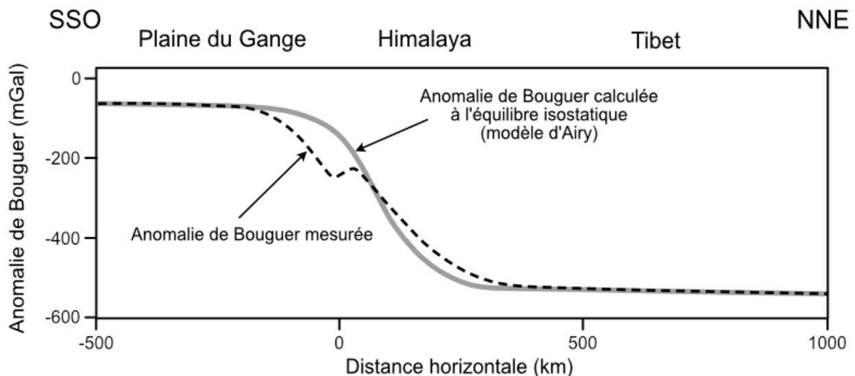
**Figure 9.** Anomalie de Bouguer. Trait pointillé : valeur de l'anomalie de Bouguer à travers le nord de l'Inde et l'Himalaya-Tibet. Trait plein : anomalie de Bouguer calculée dans un modèle d'équilibre isostatique d'Airy.
