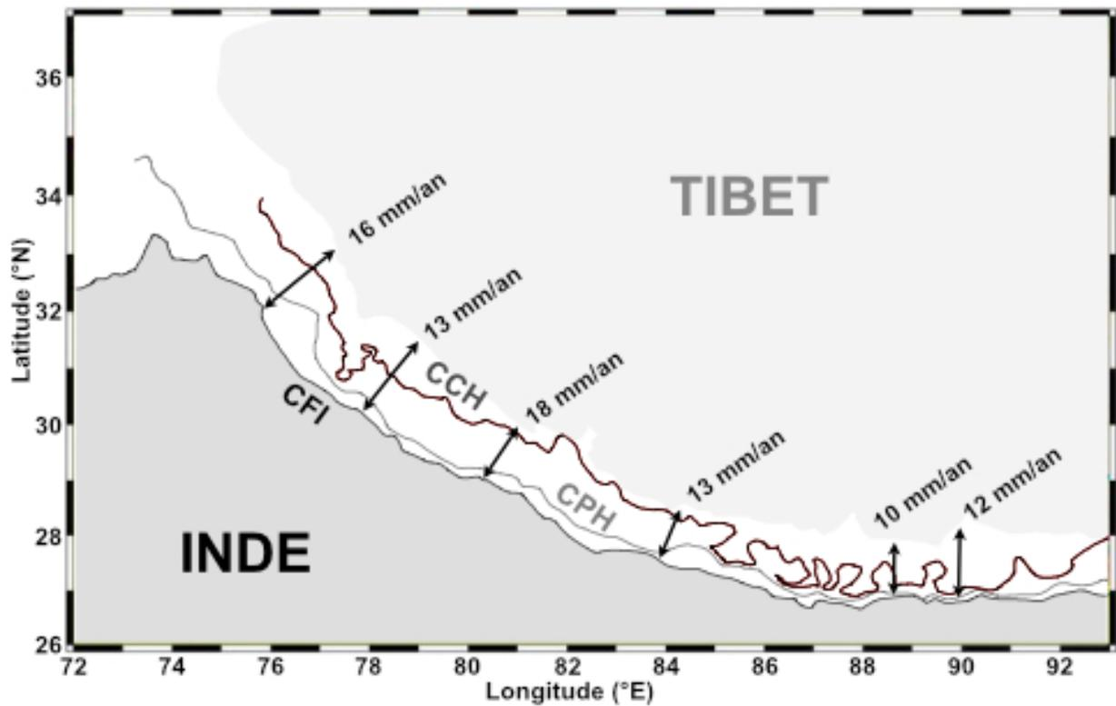
**Figure 3.** Taux de raccourcissement le long de l'arc himalayen, déterminés par GPS. CCH = Chevauchement Central Himalayen ; CPH = Chevauchement Principal Himalayen ; CFI = Chevauchement Frontal Indien.
