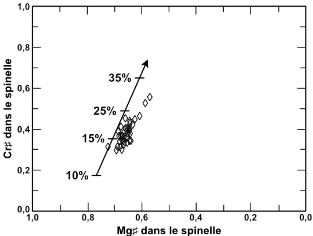
**Figure 13.** Géochimie des roches A.  $Cr\# = Cr/(Cr+Al)$  ;  $Mg\# = Mg/(Fe+Mg)$ . La flèche noire montre la composition théorique des spinelles en fonction du taux de fusion partielle subi par la roche. Les losanges correspondent à la composition des spinelles de la roche A.
