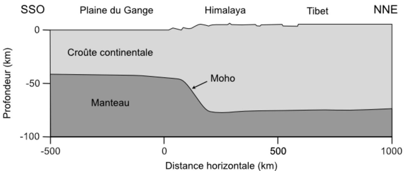
**Figure 8.** Profondeur du Moho sous l'Inde et l'Himalaya-Tibet.
