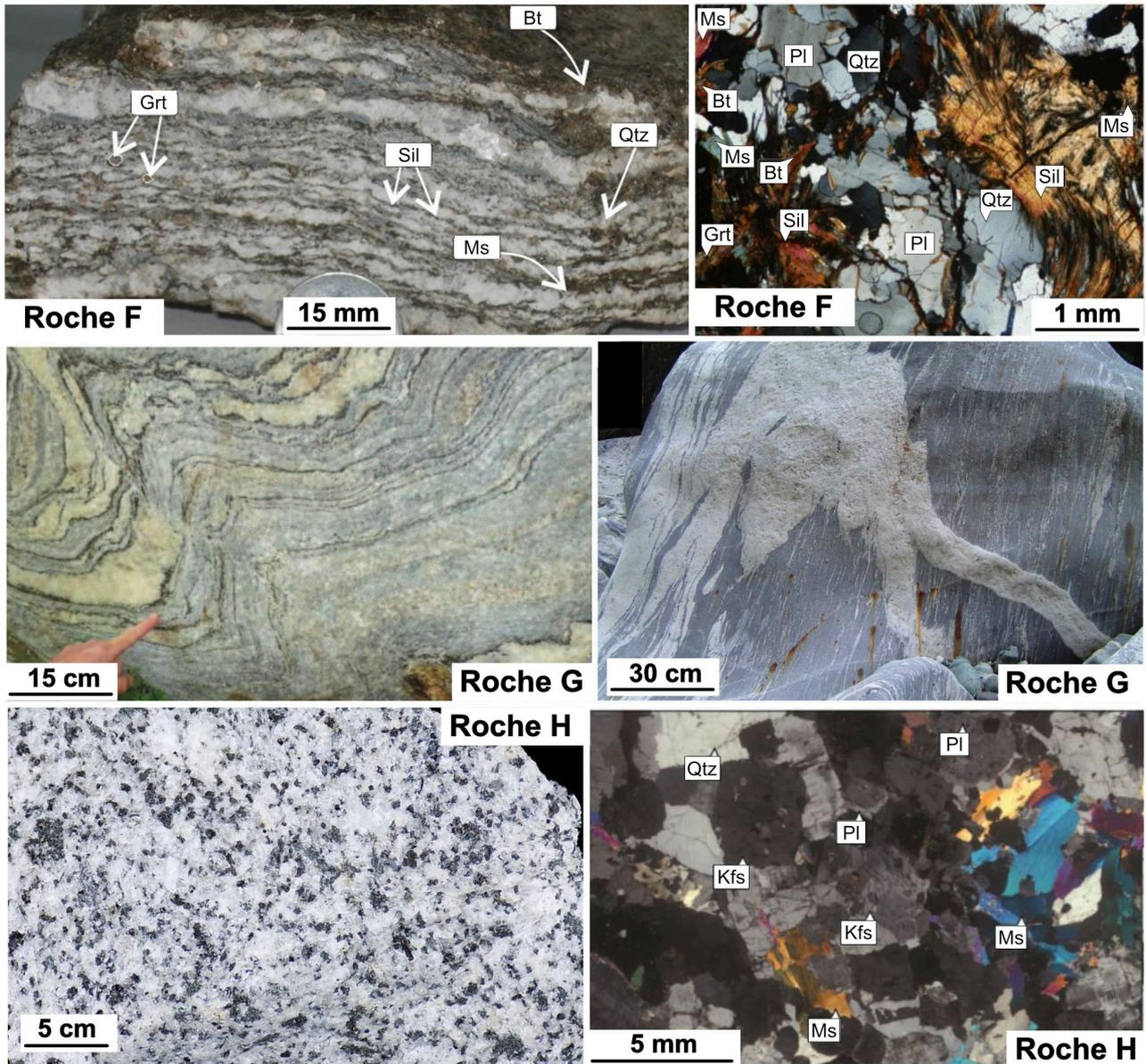
**Figure 16.** Échantillons et lames minces (en lumière polarisée analysée) des roches F, G et H.
