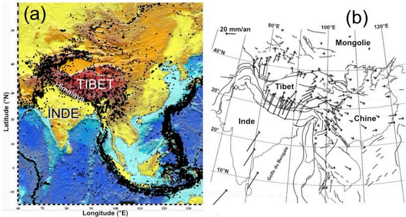
**Figure 1. (a)** Topographie et sismicité en Asie. Les teintes bleues correspondent à la bathymétrie. Les teintes jaunes à rouges indiquent des altitudes positives ; en jaune, les altitudes inférieures à 1000 mètres, en rouge les altitudes supérieures à 3000 mètres. Les points noirs représentent les séismes. **(b)** Déplacement mesuré par GPS, à Eurasie fixe. La longueur des flèches indique la quantité de déplacement horizontal (échelle sur la figure en haut à gauche).
