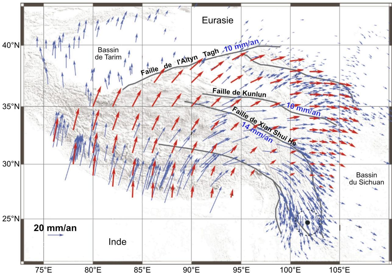
**Figure 4.** Carte montrant le champ de vitesses déterminé par GPS (flèches bleues) dans et autour du plateau tibétain. Les flèches rouges représentent la rotation globale du plateau. Les traits noirs pleins représentent les principales failles actives du plateau. Les valeurs en bleu indiquent les vitesses de déplacement horizontal estimées sur chacune des trois failles considérées.
